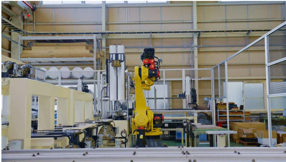
カメラで撮影したワークを取り出す走行軸付のロボットです。
