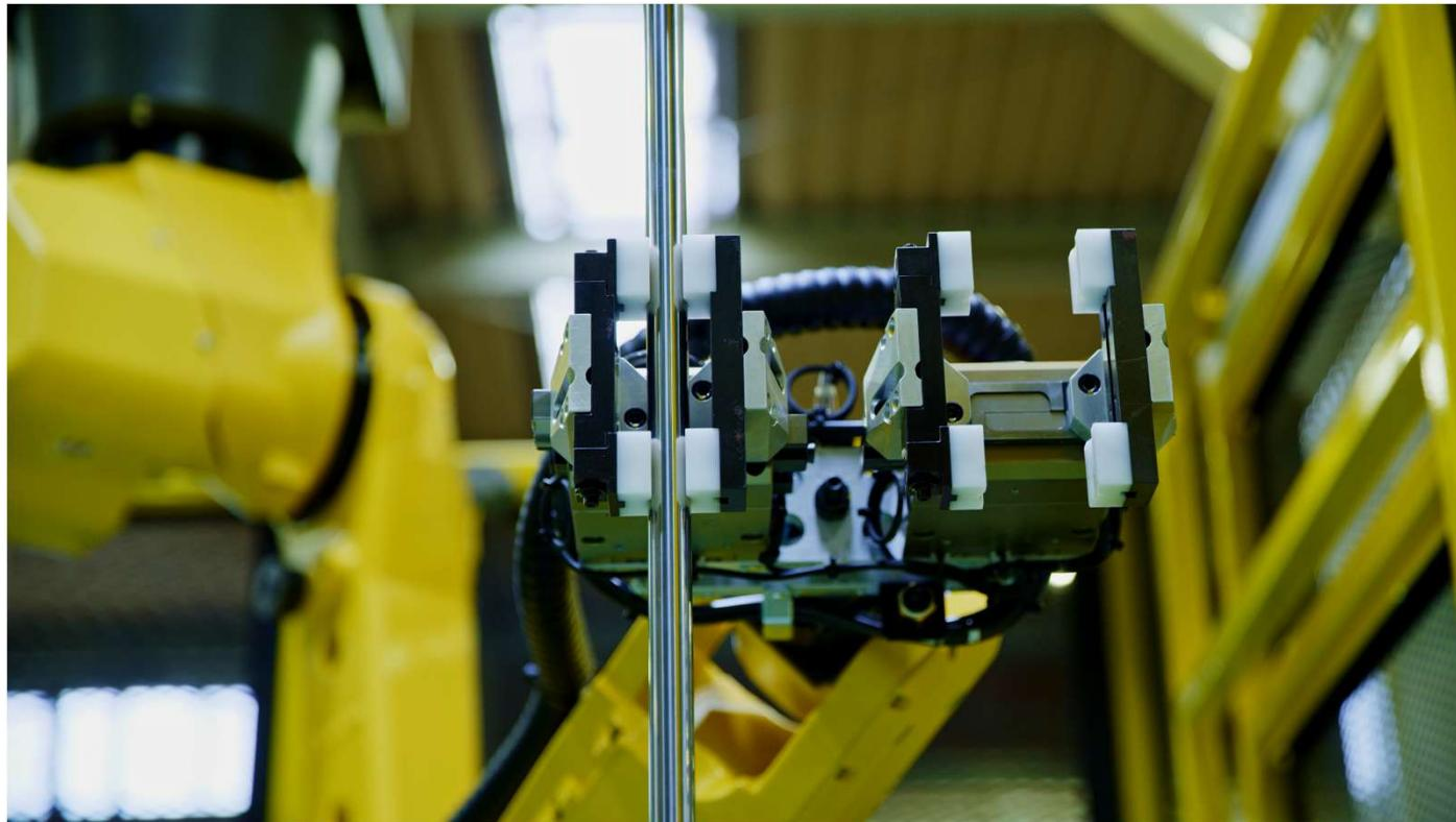
多関節ロボットをガントリー式の天吊りにて移動させる装置です。
